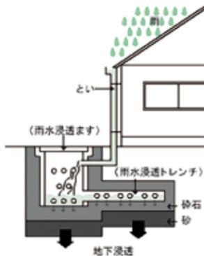
雨水浸透ます・雨水浸透トレンチ
